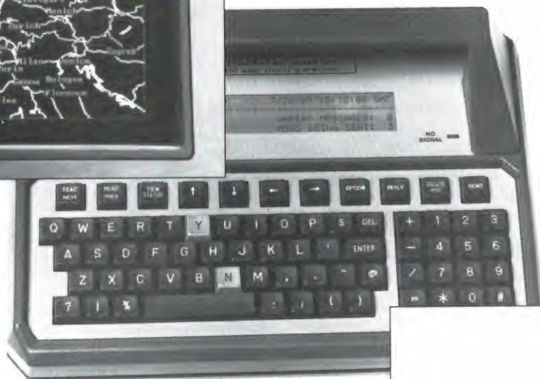
De terminal zoals die in de vrachtwagen is aangebracht, klein en handzaam maar toch voorzien van alle noodzakelijke toetsen en functies.
